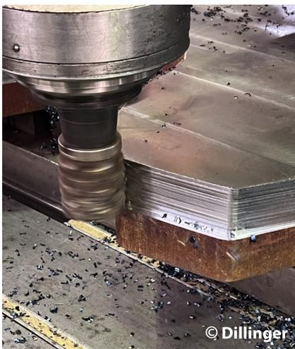
DILLIDUR-Stähle lassen sich trotz ihrer hohen Festigkeit und Härte gut zerspanen. Allerdings sind einige Grundregeln bei der Bearbeitung dieser gehärteten Stähle zu beachten. Insbesondere sollten Vibrationen möglichst vermieden werden. Es empfiehlt sich daher, auf einer möglichst steifen Maschine zu arbeiten und den Abstand zwischen Werkstück und Maschine (Säule) möglichst gering zu halten. Ebenso ist eine feste Einspannung des Werkstückes auf dem Tisch ratsam.
