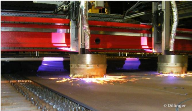
Im Gegensatz zum Laserschneiden eignet sich das Plasmaschneiden auch für Blechdicken bis ca. 60 mm. Die Schnittfuge und die Wärmeinflusszone sind jedoch etwas breiter.
