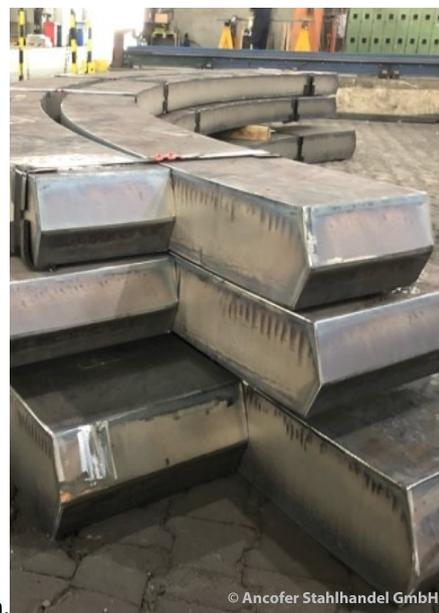
**Brennschnitt DILLIMAX 690**
