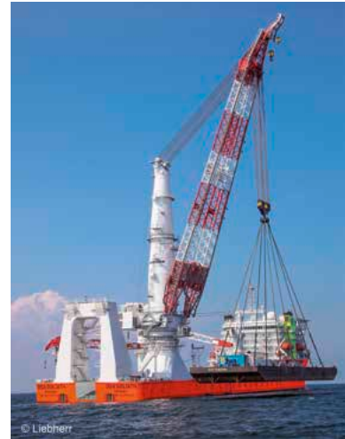
DILLIMAX: Anwendung im Offshore-Bereich
