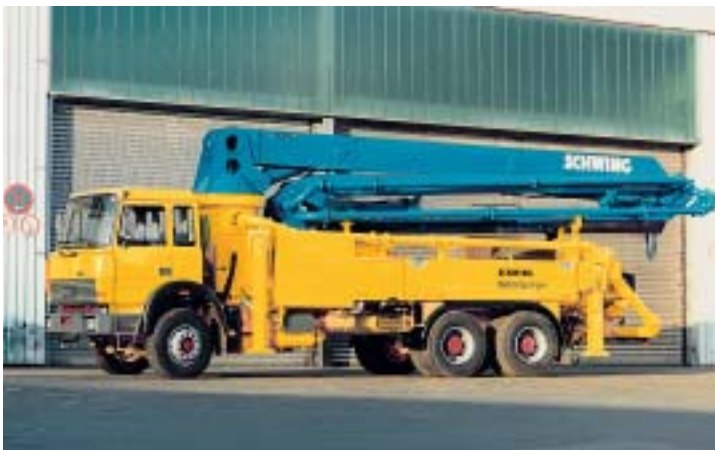
Betonpumpe von Schwing.
